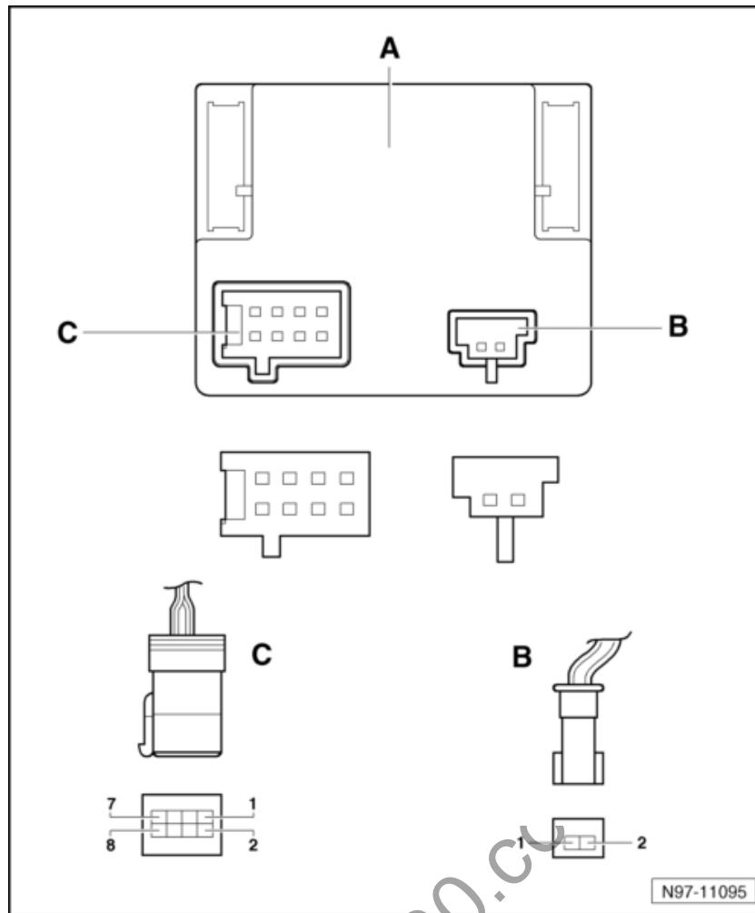
**转向柱电子装置控制单元 -J527-****插头连接:****A - 5芯插头连接 -T5-****B - 4芯插头连接 -T4k-****C - 16芯插头连接 -T16a-****D - 4芯插头连接 -T4-**
