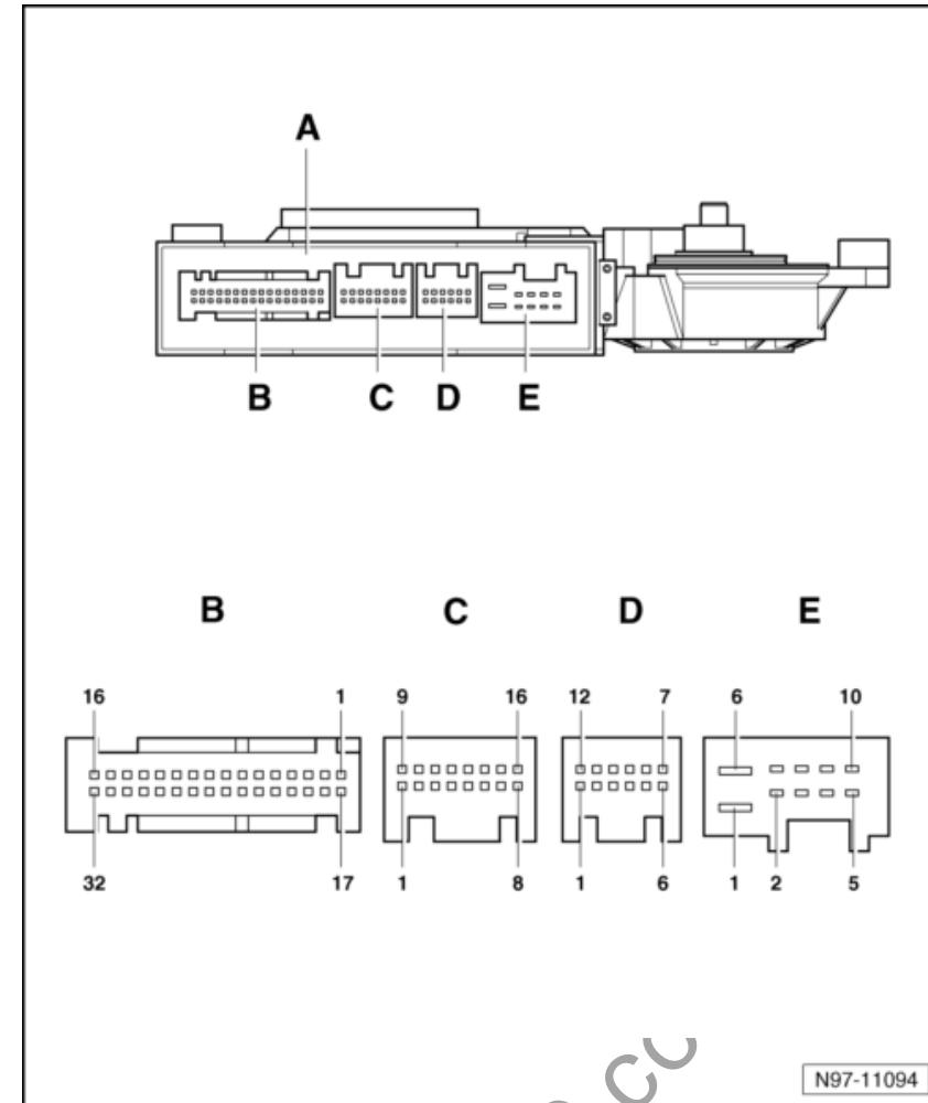
**带记忆功能的座椅调整和转向柱调整装置的控制单元 -J136-****安装位置:**
