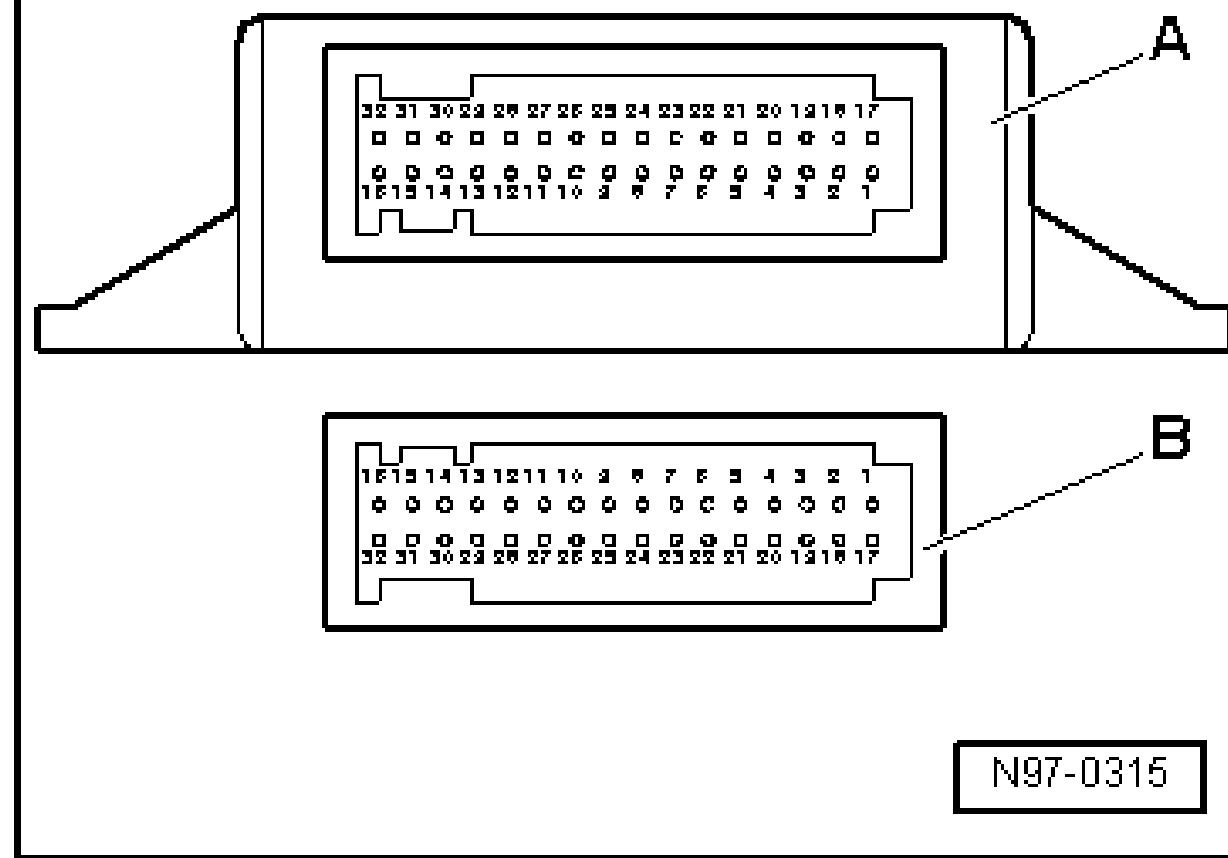
组合仪表中的控制单元 -J285- / 数据总线诊断接口 -J533-
